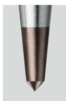
Centerpansen uit gereedschapsstaal zijn alleen geschikt voor gebruik op materialen met een hardheid < 40 HRC. Voor hardere materialen dient u centerpansen met hardmetalens punt te gebruiken (zie afbeelding).
