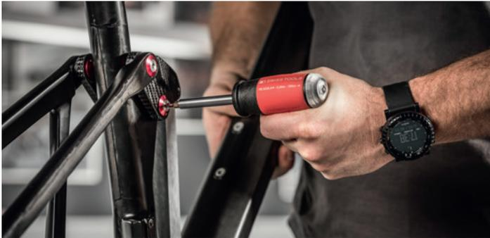
Drehmomentwerkzeuge sind die richtige Wahl für Arbeiten, die ein konstantes, exaktes und wiederholgenaues Anzugmoment verlangen: die Sicherheit der Schraubverbindung wird dadurch gewährleistet und/oder Schäden an Schraube oder Werkstück werden vermieden.
