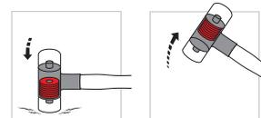
Die Scheiben werden beim Aufschlag nach unten geschleudert und fangen den Rückschlag auf. Dadurch entsteht ein satter, präziser Schlag.
