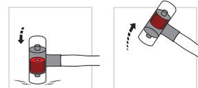
Al golpear, los discos se aceleran hacia abajo absorbiendo el rebote. De esta forma se garantiza un golpe contundente y preciso.
